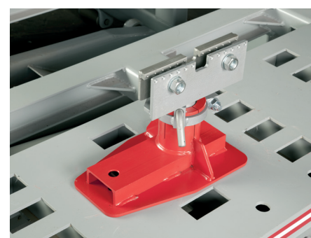
Захваты за отбортовку цангового типа с большим числом степеней свободы.
